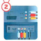
Подключите антенный кабель к антенному входу цифровой приставки. Подключите видео- и аудио кабель к соответствующим разъемам на телевизоре и цифровой приставке.
