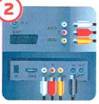
Подключите антенный кабель к антенному входу цифровой приставки. Подключите видеои аудио кабель к соответствующим разъемам на телевизоре и цифровой приставке.
