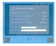
Введите: Диапазон — UHF; Частотный канал — SN; Номер телевизионного канала (ТВК); Ширина полосы (или полоса пропуска) —  $8\,\mathrm{MFu}$
